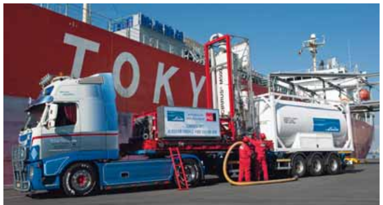
Ontgassing op basis van CIRRUS cryogene condensatie. Een mobiele unit van AQ in Antwerpen, samenwerkingspartner van Linde Gas Benelux
